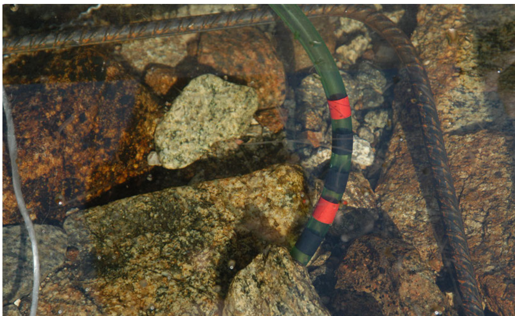
Figur 7. Måling av skjul ved hjelp av en 13 mm tykk plastslange som føres inn i hulrom mellom steinene innenfor en kvadratisk metallramme på 50 x 50 cm.
