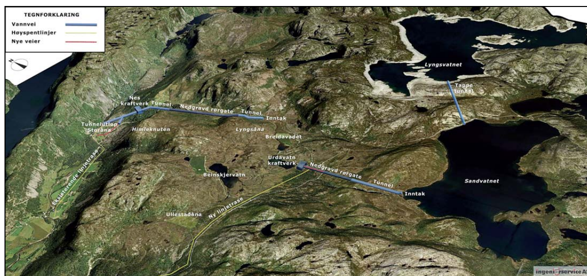
Figur 1. Skisse over tiltaket med røyrgater, tunnellar og kraftstasjonar (Lyse produksjon)
