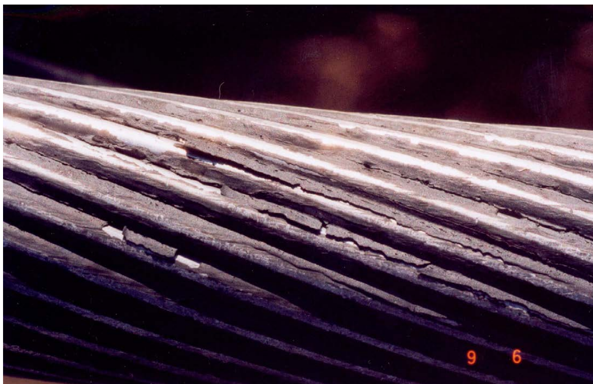
Figur 6. Stålaluminiumline (Grackle) med primer. Linen har dårlig drenering pga. belegg som tetter spaltene mellom trådene i ytre lag. Foto: S. Refsnæs.
