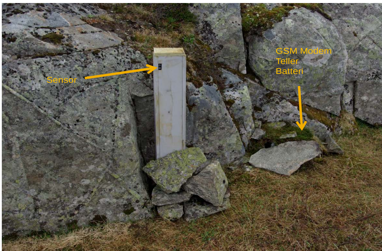
Viser prinsipp for montering av automatisk teller. I de fleste tilfeller er substrat for sensor montert på trær eller i steinvarde. Foto: Vegard Gundersen
