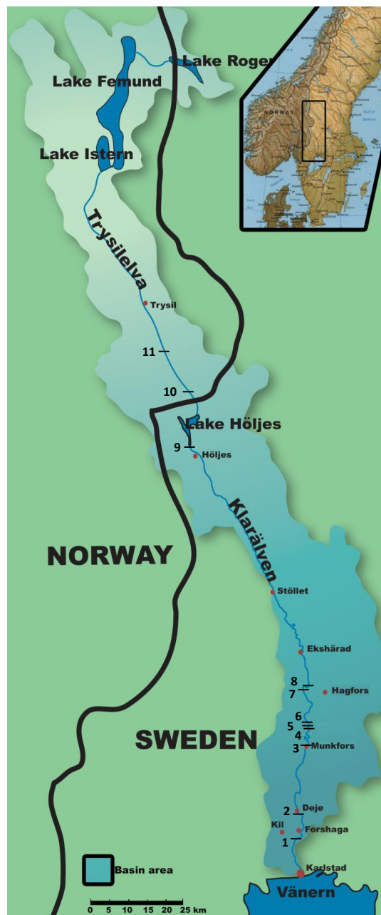
Figur 1. Kart over Klarälven / Trysilelva / Femundvassdraget fra Femunden til Vänern (modifisert etter: sv.wikipedia.org). Tallene 1 – 11 indikerer plassering av kraftverk. 1: Forshaga, 2: Deje, 3: Munkfors, 4: Skymnäs, 5: Forshult, 6: Krakerud, 7: Skoga, 8: Edsforsen, 9: Höljes, 10: Lutufallet og 11: Sagnfossen
